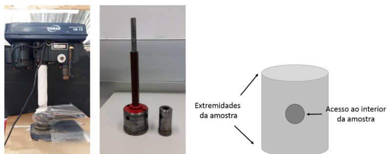
Figura 1 – Para retirar as alíquotas de rocha, utilizou-se uma furadeira de bancada (imagem à esquerda), à qual foram acopladas brocas do tipo serra copo de 25 ou 50 mm (imagem central), com as quais foram feitas perfurações na face longitudinal de cada amostra (conforme esquema indicado na imagem à direita, que representa uma amostra de rocha de reservatório).
